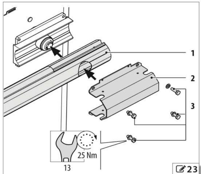
9. (🔧 24) Insertar la cubierta 1 y fijar con los tornillos 2.
